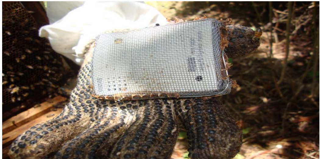
Figura 2 – Proteção do Data Logger com tela metálica contra a propolização dos sensores.
