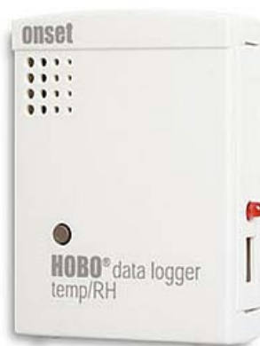
Figura 1 – Data Logger utilizado para registro da temperatura e umidade relativa do ar. Fonte: Imagem extraída do site microdaq.
