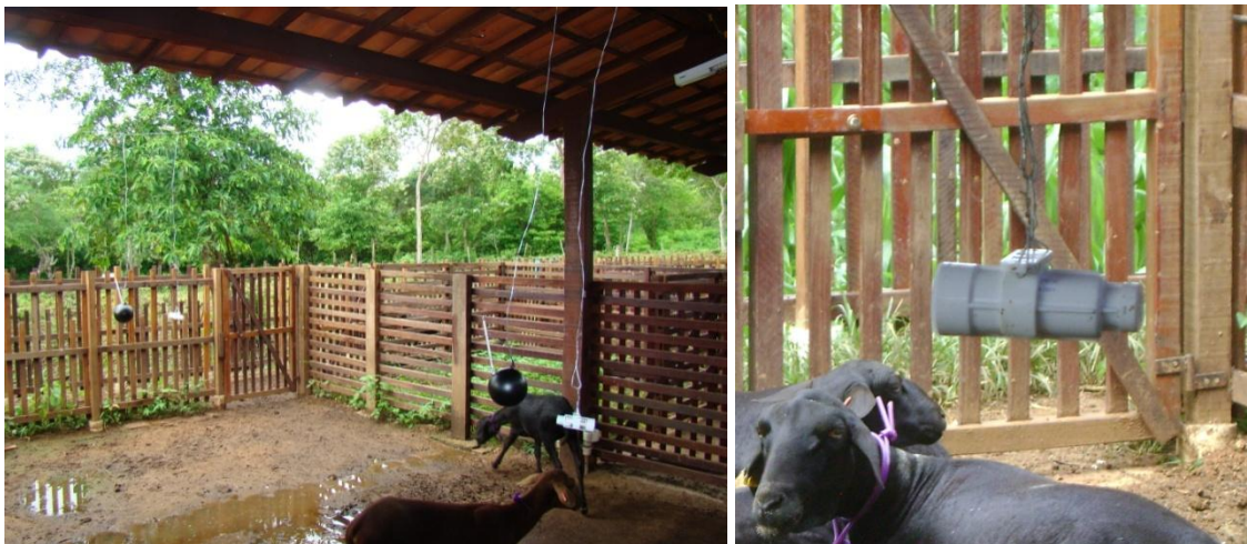
Figura 2: Distribuição das miniestações metereológicas e Data loggers no aprisco.
